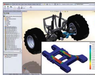
Verwenden von Spitzenlasten aus Tests oder aus SolidWorks Motion, um die Lebensdauer kritischer Komponenten abzuschätzen.
