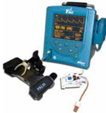
Das erste kontinuierliche, nicht-invasive Überwachungssystem für den arteriellen Blutdruck, entwickelt von Tensys Medical Inc.
