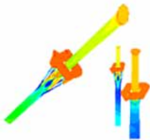
Abbildung 7: Neumag verbessert mit SolidWorks Flow Simulation die Konstruktion von Düsen.
