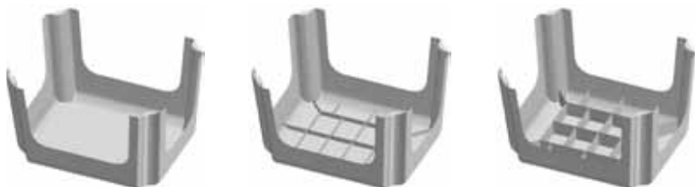
Abbildung 5: Entwurfsvarianten mit Versteifungslamellen
