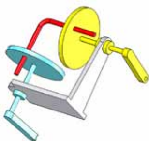
Abbildung 5: Ein einfacher 3D-Mechanismus ist „per Hand“ schwer zu analysieren, stellt jedoch für die Bewegungssimulation überhaupt kein Problem dar.
