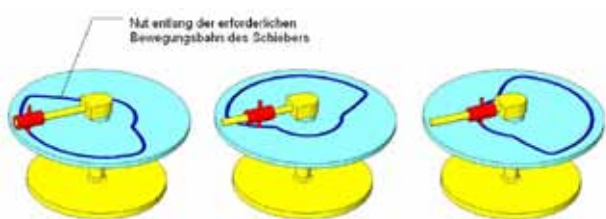
Abbildung 10: Die Bewegung des Schiebers wird auf der rotierenden runden Platte nachgezeichnet, um ein Kurvengliedprofil zu erstellen. In der Abbildung wird dies mit einer in die Platte geschnittenen Nut veranschaulicht.
