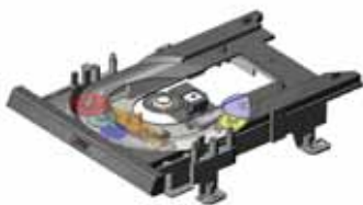
Abbildung 8: Ein CD-Laufwerk kann mithilfe der Bewegungssimulation problemlos analysiert werden, obwohl es sich dabei um einen komplexen Mechanismus handelt.
