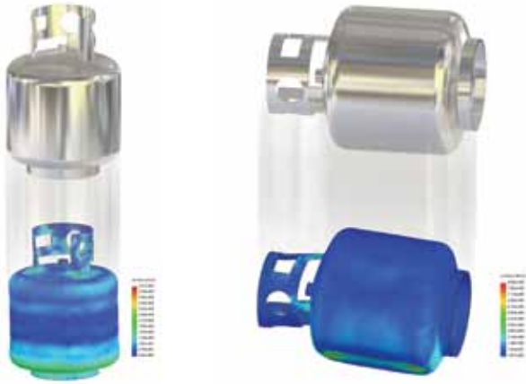
Abbildung 6: Bei Propangasflaschen, die in unterschiedlichen Ausrichtungen fallengelassen werden, sind deutliche Unterschiede bei den Spannungsergebnissen zu verzeichnen.
